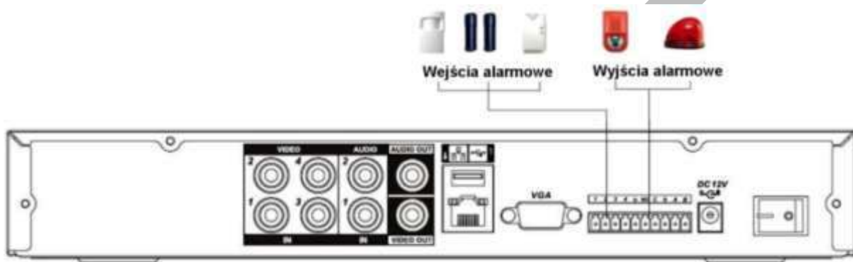
Rys. 3-4b. Podłączenie wejść i wyjść alarmowych w rejestratorach. serii LE-AS.
