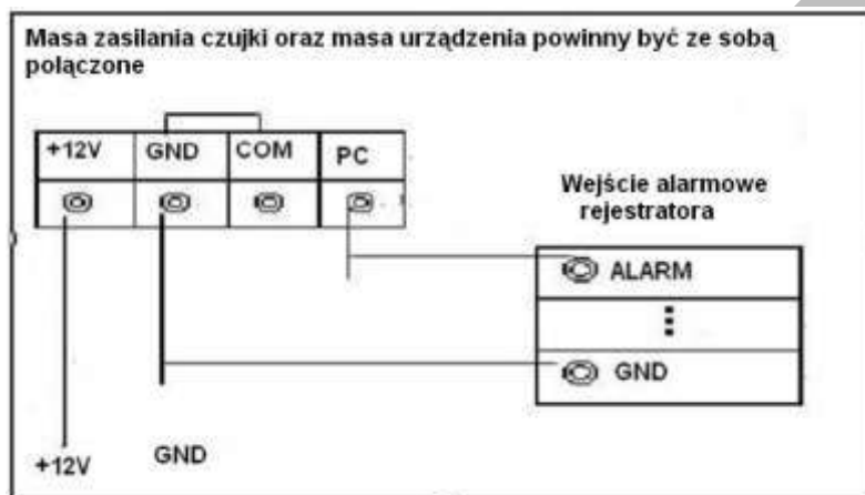
Rys. 3-6. Schemat podłączenia czujek do wejść alarmowych.
